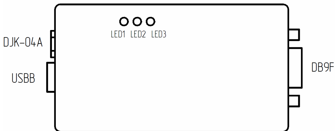
Рисунок 1. Основные разъемы TA1-USB-01.
